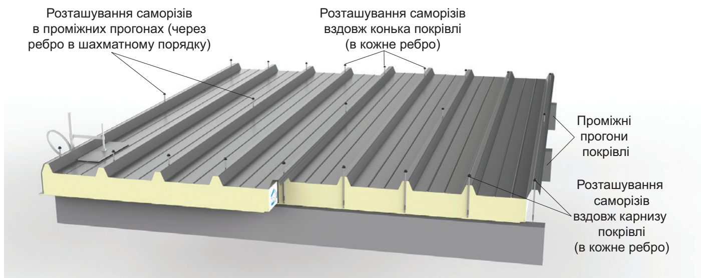
Рекомендована схема розташування саморізів при монтажі покрівельних сендвіч-панелей
